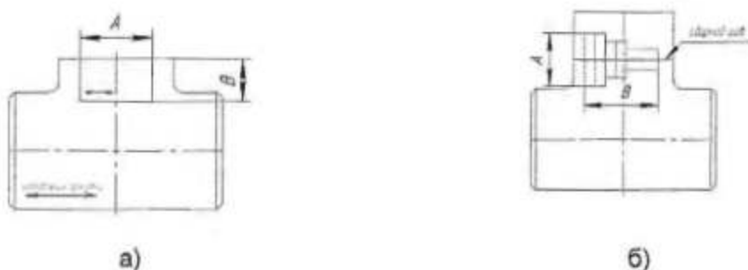
Рисунок 20 - Схема вырезки темплета из тройника штампованного (ТШ) и тройника штампованного с кольцом переходным (удлинительным) (ТШ КП)
