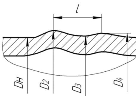
Рисунок 2 - Схема определения волнистости (гофры)
