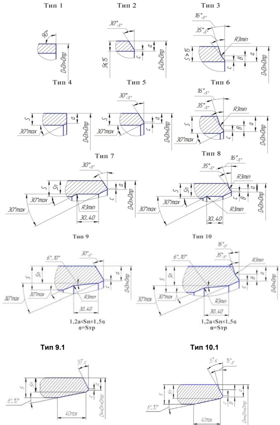
Рисунок 15 - Варианты разделки кромок торцов детали с наружным диаметром, равным диаметру присоединяемой трубы
