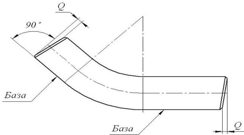
Рисунок 13 - Отклонение от перпендикулярности торцов для отводов
