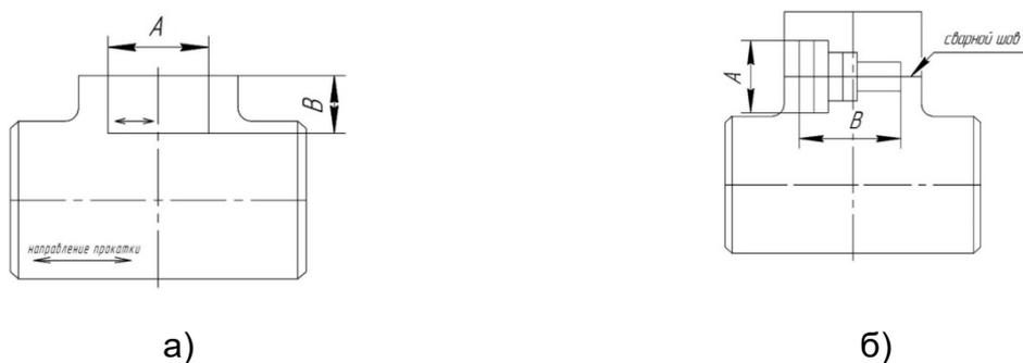
Рисунок 20 - Схема вырезки темплета из тройника штампованного (ТШ) и тройника штампованного с кольцом переходным (удлинительным) (ТШ КП)
