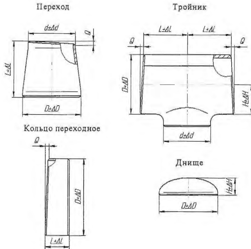
Рисунок 14 - Отклонение от параллельности торцов для переходов и переходных колец
